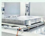
電動車技術日新月異，其中電池技術的發展更是一日千里。電池為電動車的心臟，儲存驅動車輛的電力。電動車電池種類繁多，較新的有刀片電池（上圖）。刀片電池形狀狹長如刀，因而得名。刀片電池的安全性和能量密度較高，故較為常用。
